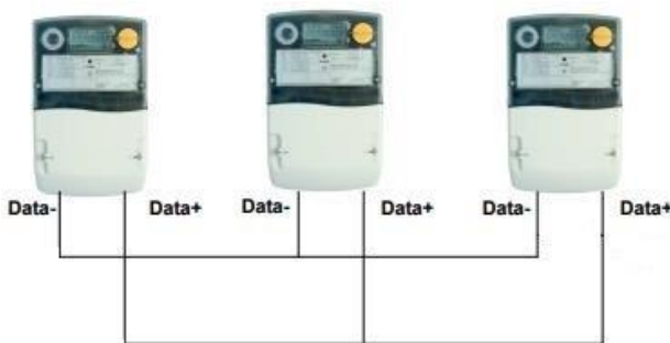
Abbildung 11: Anbindung mehrerer Lastgangzähler
