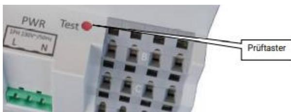
Der Prüftaster – oder Test Taster – dient zur Prüfung der Relaisfunktionen durch einen Monteur vor Ort. Durch eine Reihe kurzer Tastendrucke kann ein Test durchlaufen werden, in dem alle vier Relais der SwiSBox nacheinander jeweils einzeln aktiviert werden (Stellung A). Nach dem Test nehmen die Relais ihre vorherige Stellung wieder ein.
