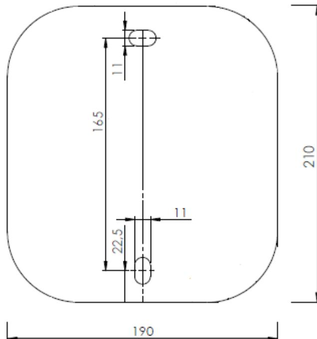
Das Gerät besitzt eine Edelstahl-Wandplatte, mit der das Gerät an der Wand befestigt wird. Mittels der zwei in der Wandplatte vorhandenen Befestigungslöcher erfolgt die Befestigung bei Verwendung von 12 mm Dübel und 10 mm Sechskant-Holzschrauben.
