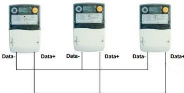
Abbildung 11: Anbindung mehrerer Lastgangzähler
